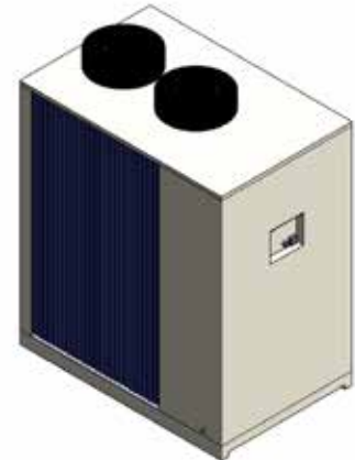
Şekil 1: Mekanik bir eleman için oluşturulmuş örnek bir BIM nesnesi
