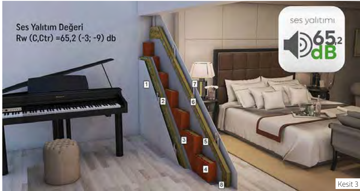
1- Alçıpan Plaka, 2- Alçı Levha Profili Sistem + Taş Yünü, 3- Kaba Sıva, 4- Ekoklinker 12, 5- Kaba Sıva, 6- Alçı Levha Profili Sistem + Taş Yünü, 7- Alçıpan Plaka, 8- DKM Fonostrip Akustik Şerit
