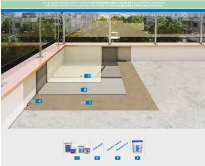
Düz çatıların su yalıtımı için sistem
